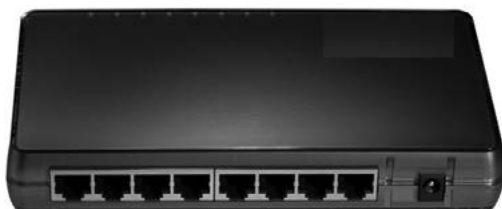
Figura 1.35 Portas LAN do switch.
